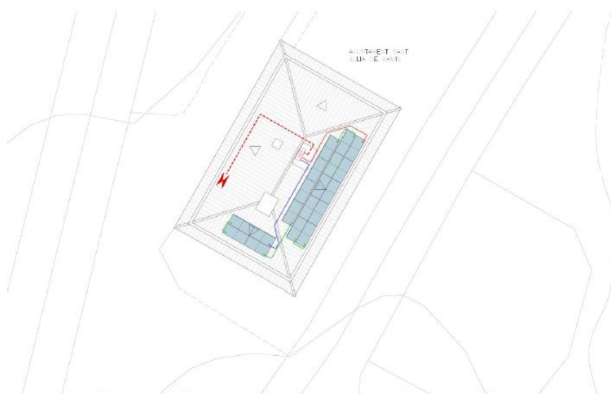
Emplaçament de les plaques fotovoltaïques a la coberta de l'edifici de l'Ajuntament de Sant Julià de Ramis
